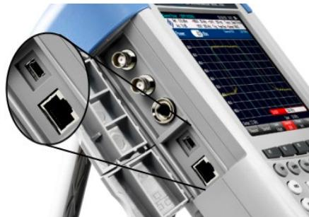
Der R&S FSH kann über USB oder LAN mit einem PC verbunden werden, um Daten in beide Richtungen zu übertragen.
