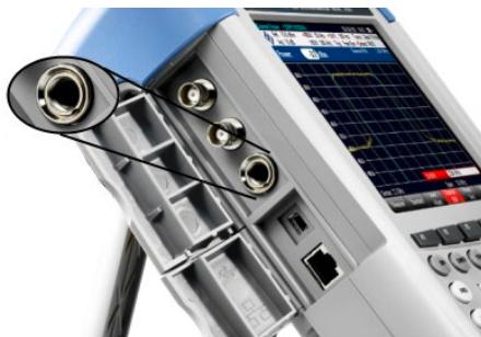
An den AUX-Anschluss sind verschiedene Zubehörteile wie beispielsweise der GPS-Empfänger R&S HA-Z240 (Bestellnummer 1309.6700.02) anschließbar.
