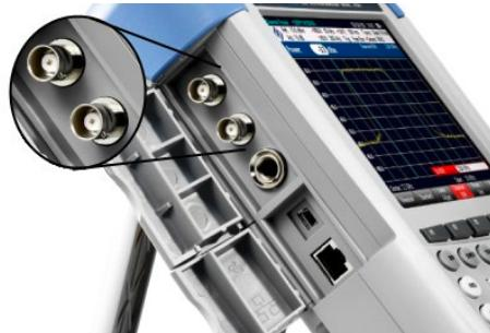
Beide BNC-Anschlüsse können für verschiedene Anwendungen konfiguriert werden. Die Namen der Anschlüsse sind auf den Innenseiten der Schutzkappen eingeprägt.
