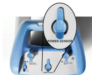
Der Anschluss ist speziell für Leistungsmessköpfe konfiguriert. Er wird sowohl zur Stromversorgung als auch für Datenübertragungen über die Schnittstelle des Leistungsmesskopfs verwendet.
